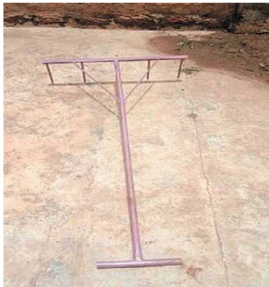
Figure 7. Rayonneur à riz testé en champ-école et co-produit localement. © IRD/IA. Sawadogo
